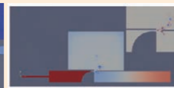
発振しているオルガンパイプの圧力と音源
