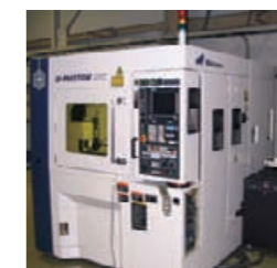
レーザー光で金型を造形する金属光造形機
