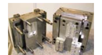
研究室で製作した金型
