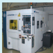
レーザー光で金型を造形する金属光造形機
