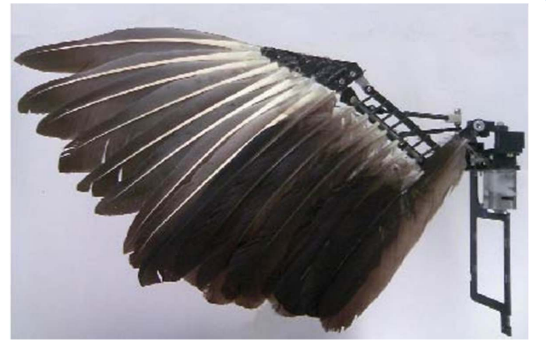
本物の羽根を用いた羽ばたき翼
